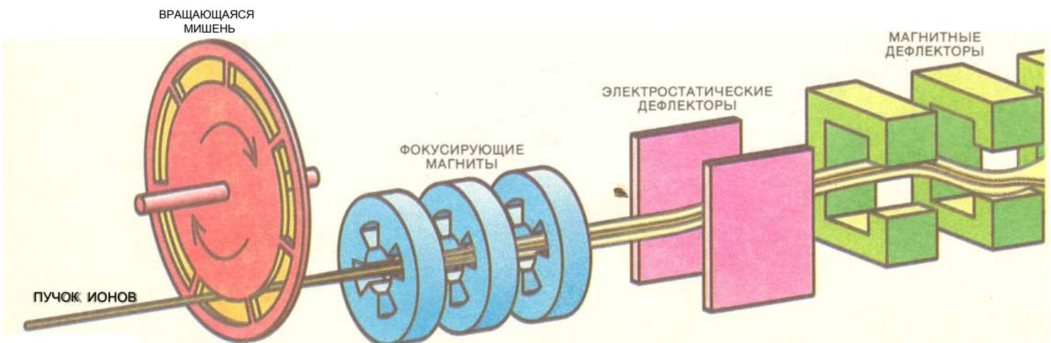
ЭФФЕКТИВНЫЙ ФИЛЬТР имеет особенно важное значение для детектирования и идентификации сверхтяжелых элементов. Фильтр SHIP (сепаратор продуктов реакций с
