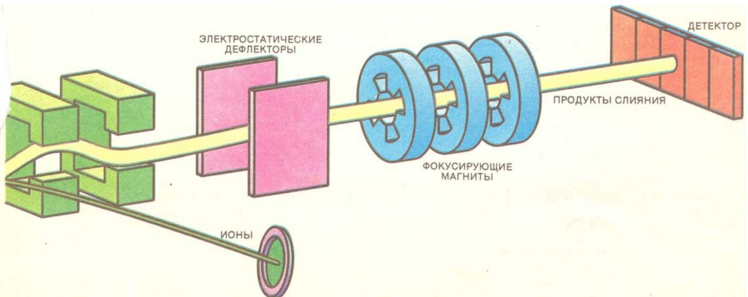
ветствующие характеристикам ожидаемых продуктов слияния, отклоняются от траектории ионного пучка. Фильтр SHIP уменьшает число тяжелых ионов в пучке в 1011 раз, а
