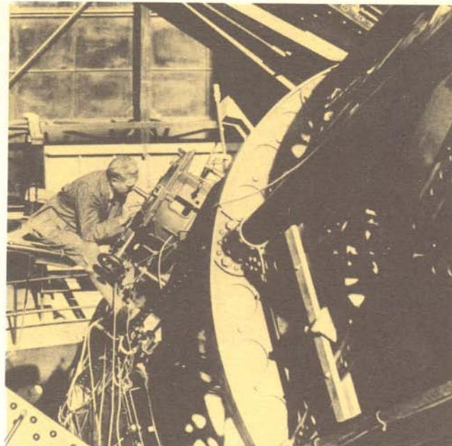
ИНТЕРФЕРОМЕТР МАЙКЕЛЬСОНА был установлен в 1920 г. на 100-дюймовом телескопе обсерватории Маунт-Вилсон. Свет от звезды отражается от двух подвижных зеркал, расположенных на каждом конце фермы Длинной 6 м. Два луча света сходятся в фокусе телескопа, где они интерферируют. Перемещая зеркала, можно добиваться исчезновения интерференционных полос. Расстояние
